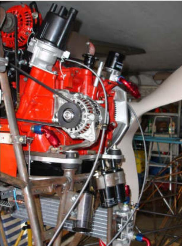
Lichtmaschine aus Gabelstapler
