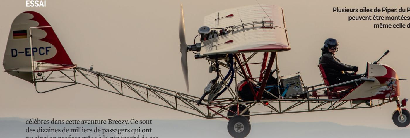
Plusieurs ailes de Piper, du PA-12 au PA-19, peuvent être montées sur le Breezy ; même celle du Cessna 172!
